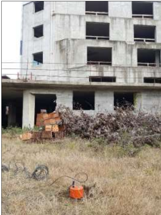
Misura del microtremore sismico mediante tecnica HVSR
